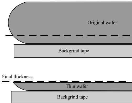
Fig. 3: Sharp wafer edge for thin die
